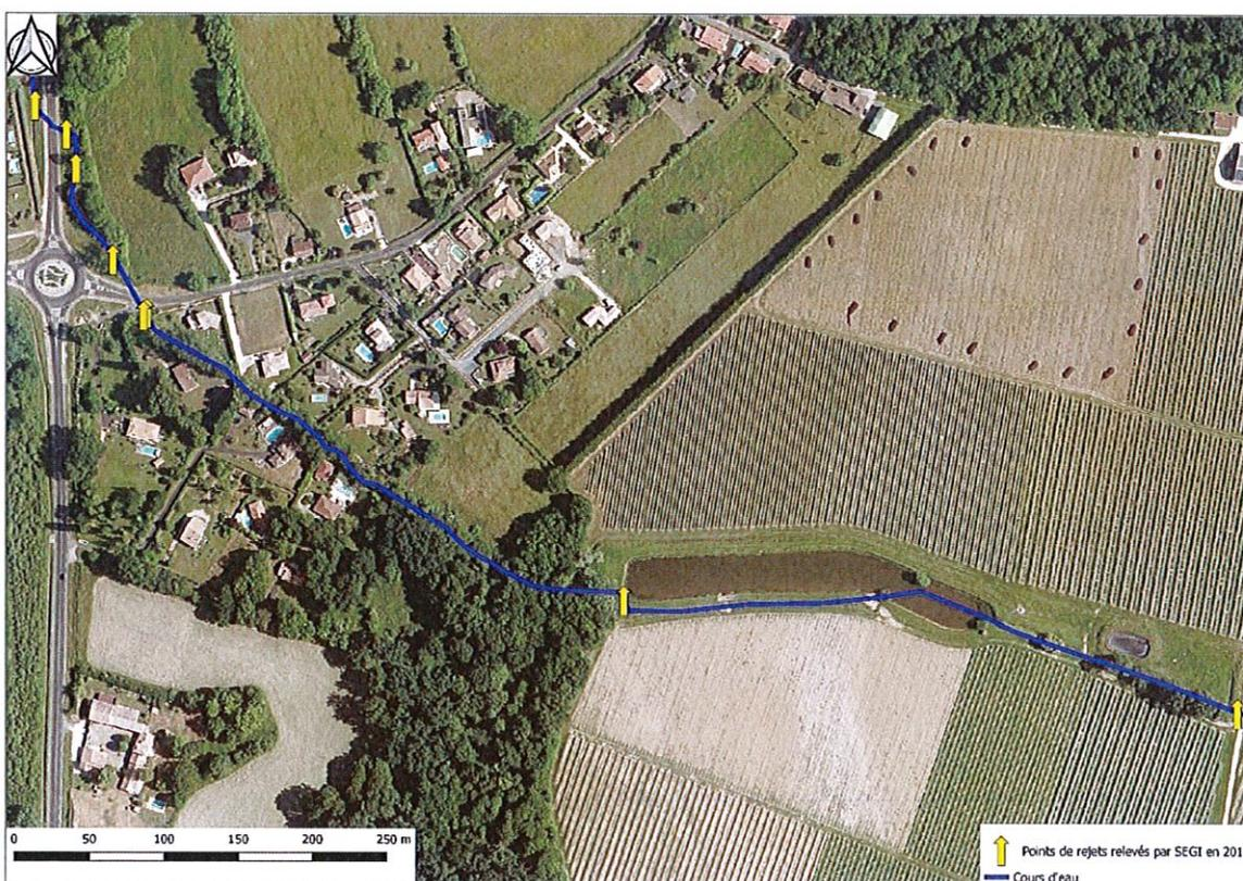
En outre, les rejets d'eaux pluviales observés au droit du secteur de l'inondation sont détaillés en annexe n°2. Ces derniers sont au nombre de 7, leur diamètre va de 30 à 60 cm et certains sont obstrués par la végétation ou par des sédiments. De plus, l'implantation de rejets perpendiculaires au cours d'eau en amont immédiat des ouvrages hydrauliques engendre de l'érosion qui mettra les ponts en péril à terme.
